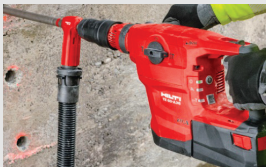
Perceuse équipée d'aspiration THE
